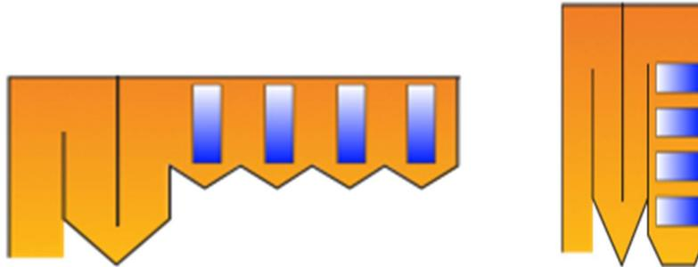
**Figura 5-17: Conceptos principales de arreglo de la caldera; horizontal o vertical (Elaboración propia)**
