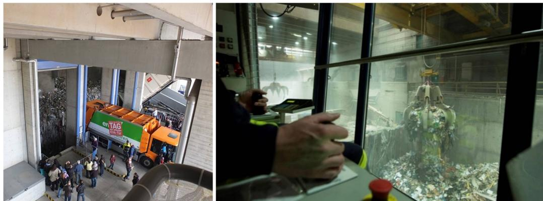
**Figura 5-15:** Sala de descarga (derecho), grúa pórtico para mezclar/transportar RSD (izquierdo), planta Winterthur, Suiza
