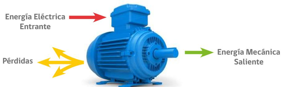
**Figura 22: Distribución de la energía en un motor eléctrico.**
